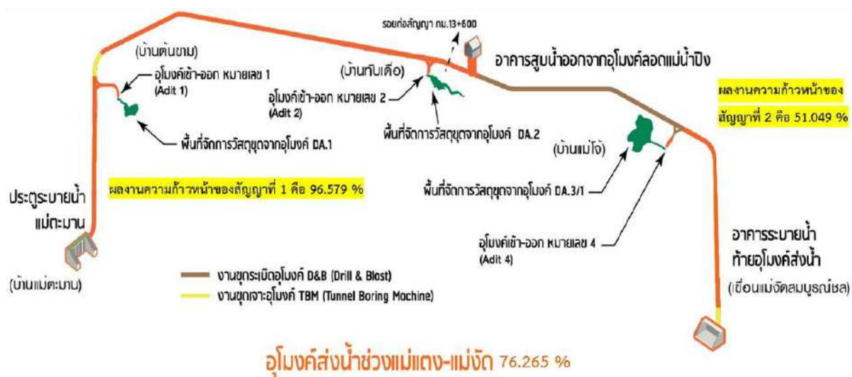
รูปที่ 1-3 ความก้าวหน้างานก่อสร้างอุโมงค์ส่งน้ำช่วงแม่แตง – แม่จัต
